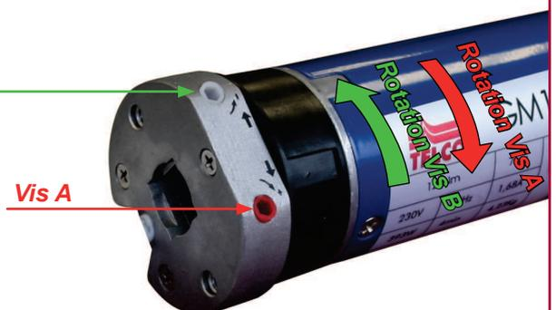
**Fin de course :** Actionner la vis vers le «+» pour plus de fermeture ou d'ouverture, vers le «-» pour moins fermeture ou d'ouverture.
